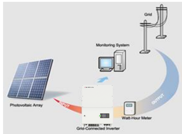
그림 5.1 태양광 발전 시스템 구성도
